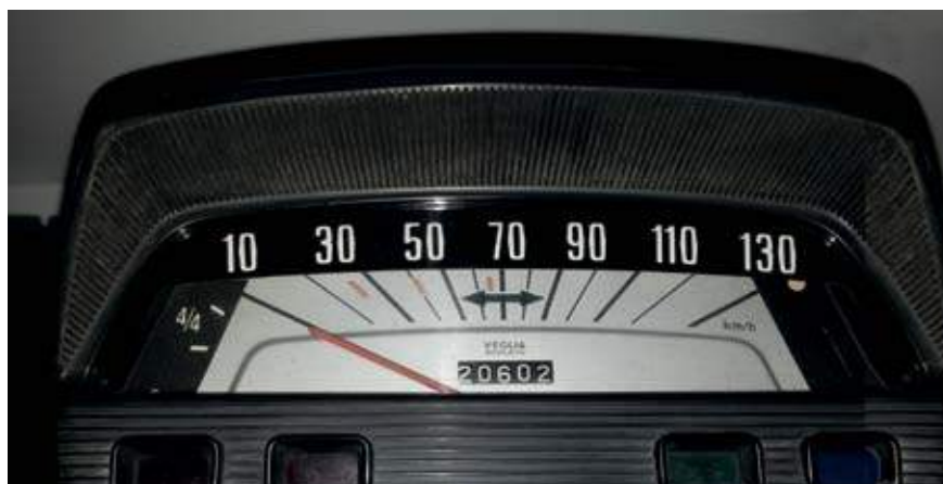
Il contachilometri della 500 L con la lancetta indicatrice del livello della benzina.
