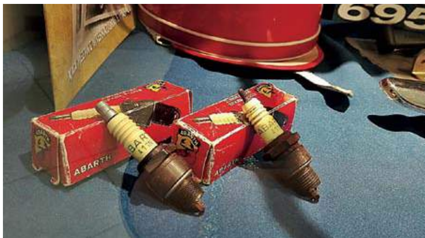
Candele Abarth esposte nel Museo Multimediale della 500. Le candele pensate per motori ad alte prestazioni non sono adatte ai motori di serie dei cinquini.
