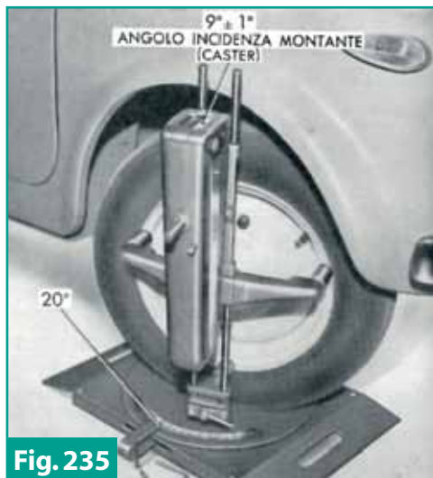
Fig. 235. - Controllo dell'angolo di incidenza del montante delle ruote anteriori. 2ª operazione: con la ruota sterzata di 20° indietro, l'indice deve indicare, sulla scala "Caster", 9°; tolleranza ammessa: ± 1°.
