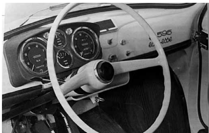
Fig. 6. L'interno di una Fiat Abarth 595 SS su base D con la prima versione di cruscotto combinato).
