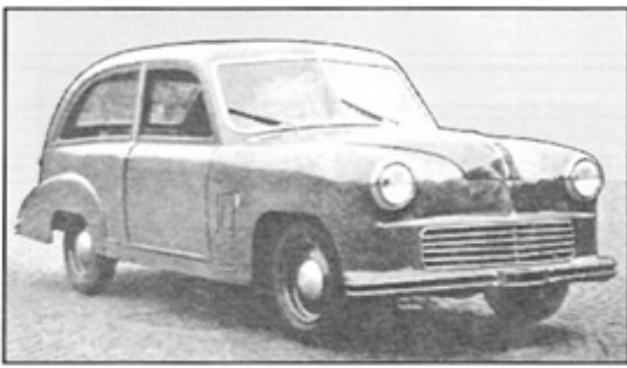
1949 Carrozzeria F. Lombardi "Saloncino" su " Fiat 1100 B" fiancate e portellone realizzati con ampi pannelli di legno. Poteva essere allestita su telaio 1100 B, 1100 BLe 1100 Trasporto FL
